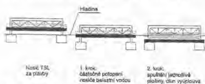
Obr. 2 – Postup vykládky člunu z nosiče
